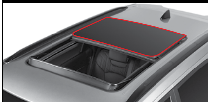
1ère and 2e position (complètement ouverte) d'ouverture de la vitre du toit ouvrant
